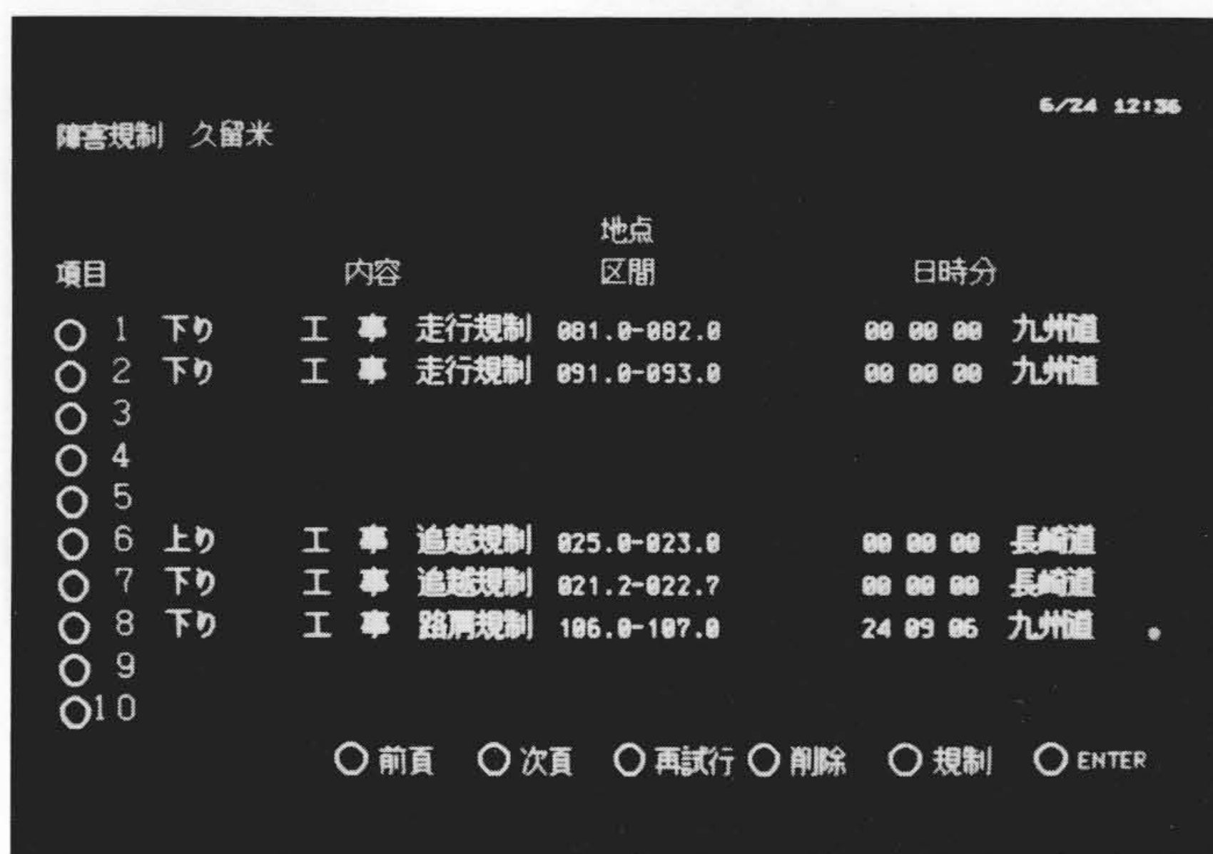
図8 障害規制リストの例 各路線の障害規制状況を、発生順にリストアップしている。
