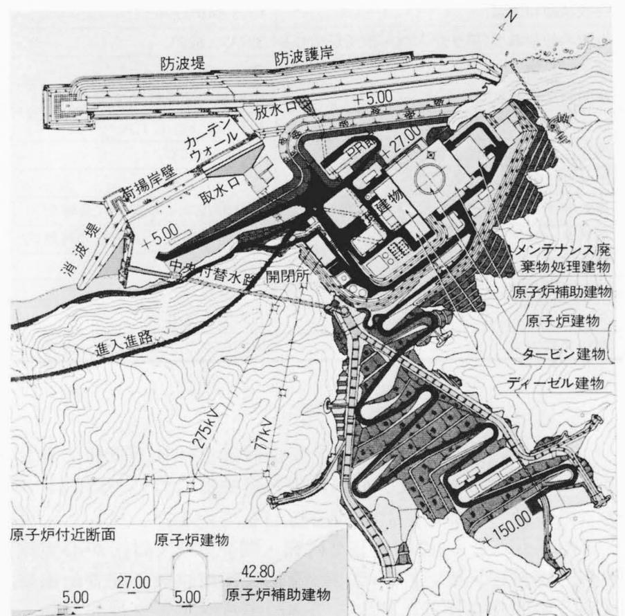
図1 「もんじゅ」発電所配置図<sup>1)</sup> 原子炉建物は標高5mに掘削した岩盤上に設置され、その周辺に原子炉補助建物などの主要構造物が設置される。なお、配置に当たっては、自然環境が保全されるよう配慮されている。
