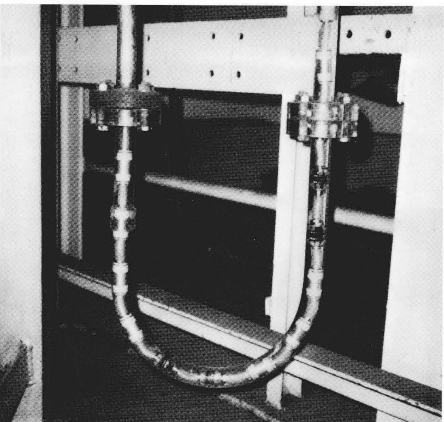
図14 伝熱管下部Uベンド部に挿入された探傷プローブ(全体システム総合試験) 探傷プローブが、ヘリカルコイル部を通過して、伝熱管下部Uベンド部を通過している状況を示す。
