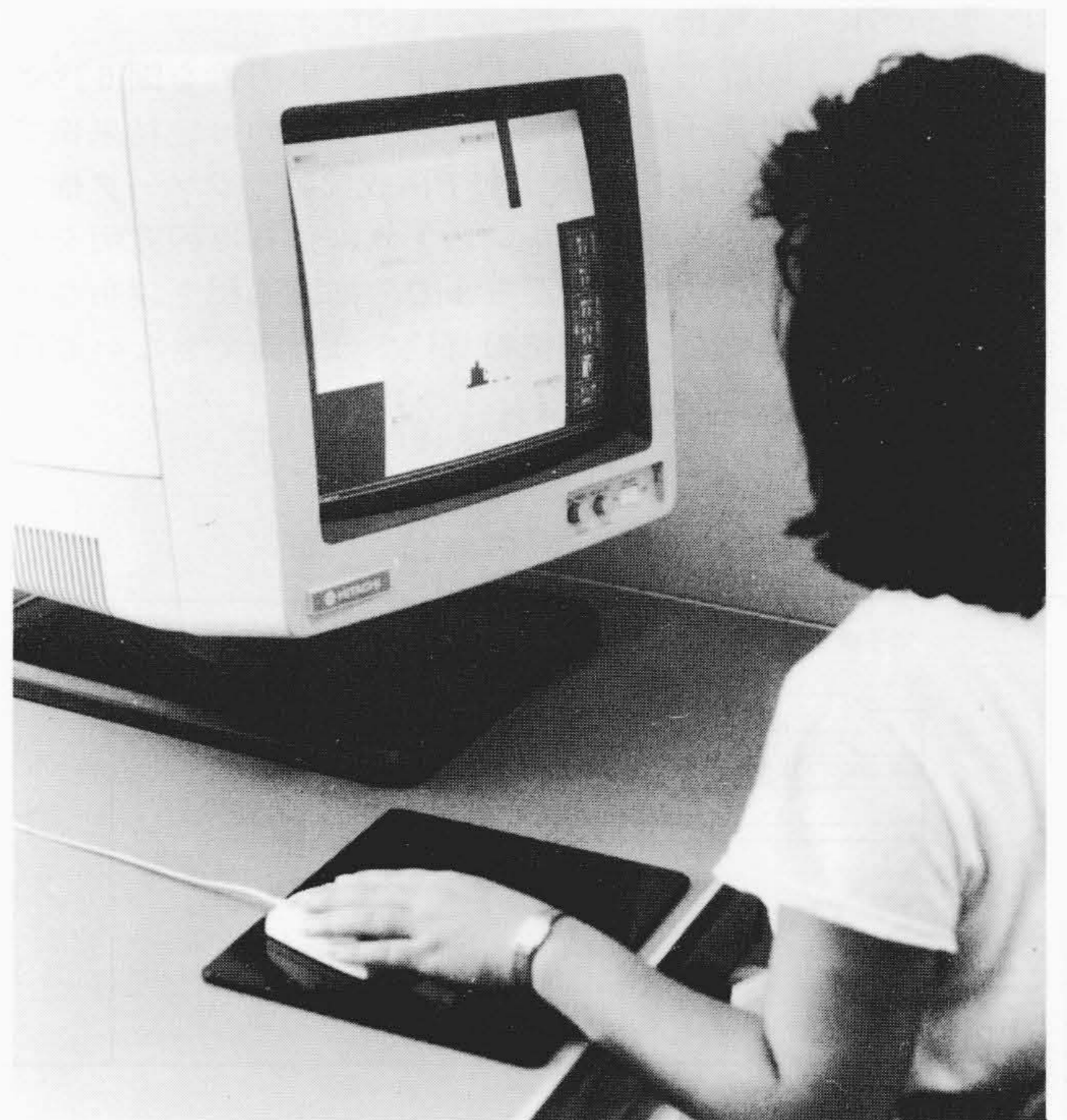
図4 TEGMAPを搭載したCAEワークステーション イメージ中心の親しみやすいマンマシンインタフェースと、システム増設の容易性を実現するために、TEGMAPはワークステーションに搭載した。
