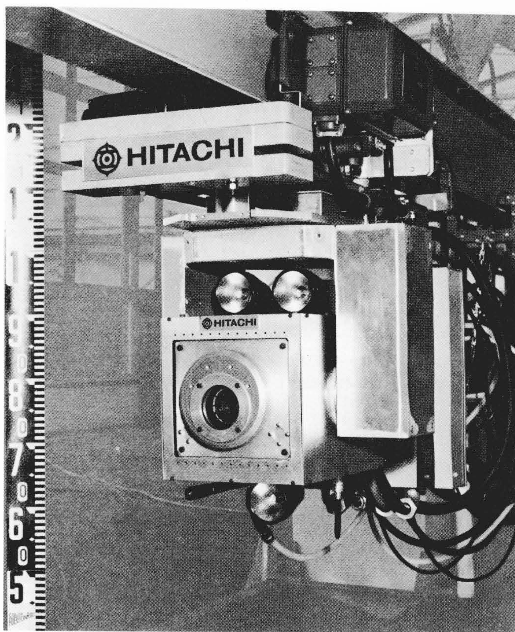
図8 電動トロリ形移動式監視装置 Iビームに沿って走行する電動トロリの下部に、電動雲台とテレビジョンカメラを搭載している。給電、通信はカーテンケーブルによる。
