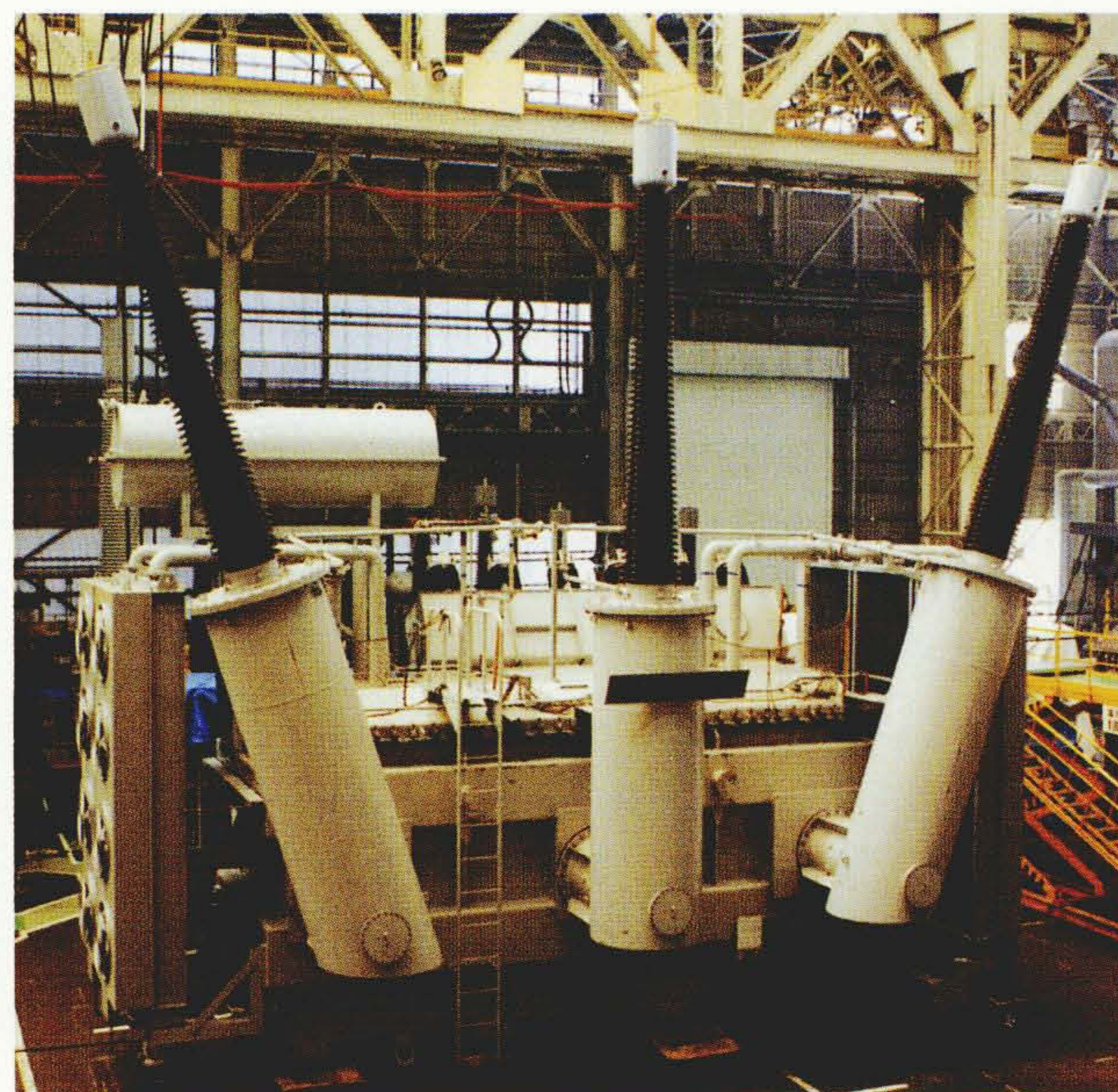
工場完成した500kV 300MVA三相変圧器
