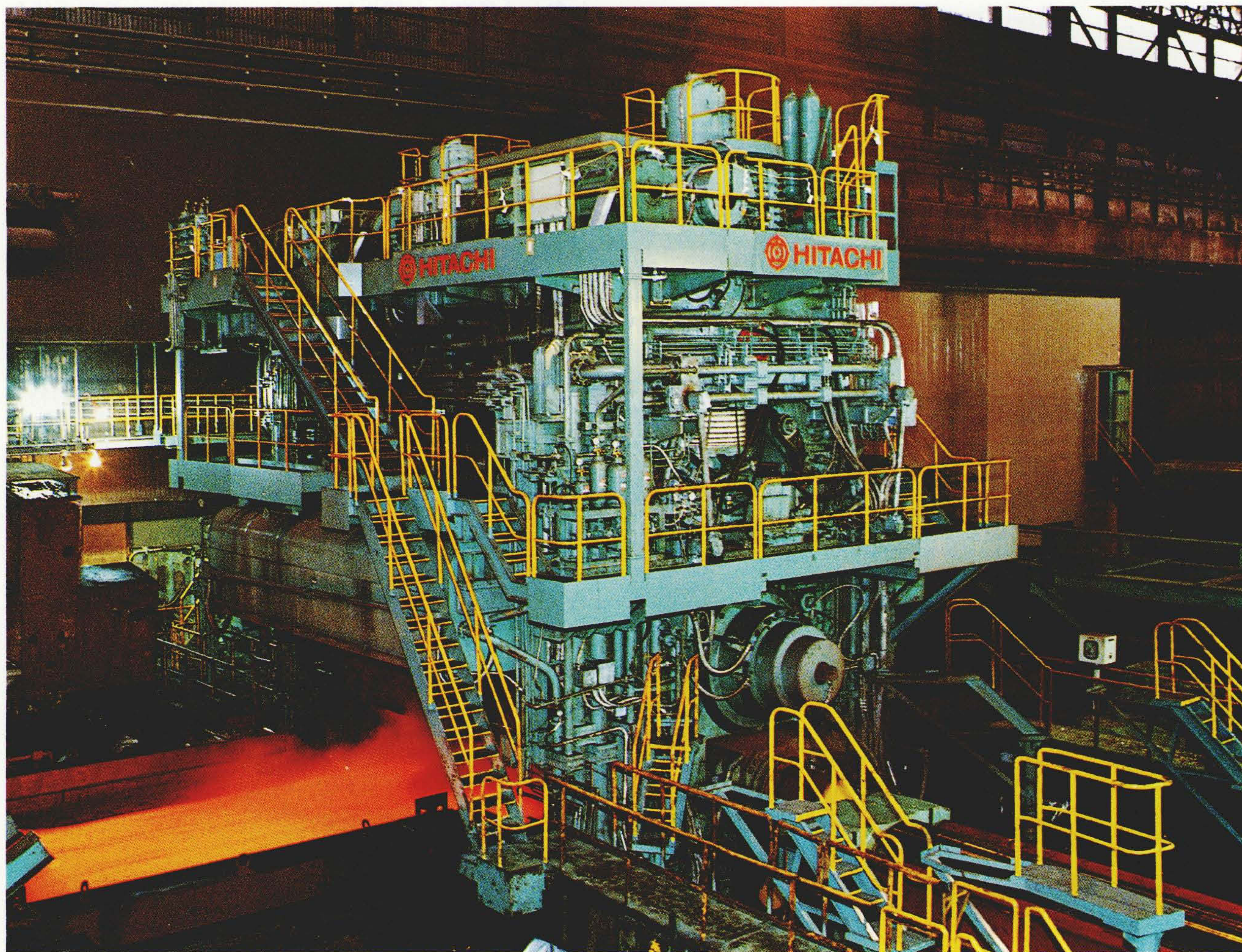
日本鋼管株式会社福山製鉄所納めHCW-MILL式厚板圧延機
