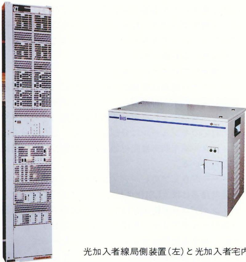
光加入者線局側装置(左)と光加入者宅内装置(右)
