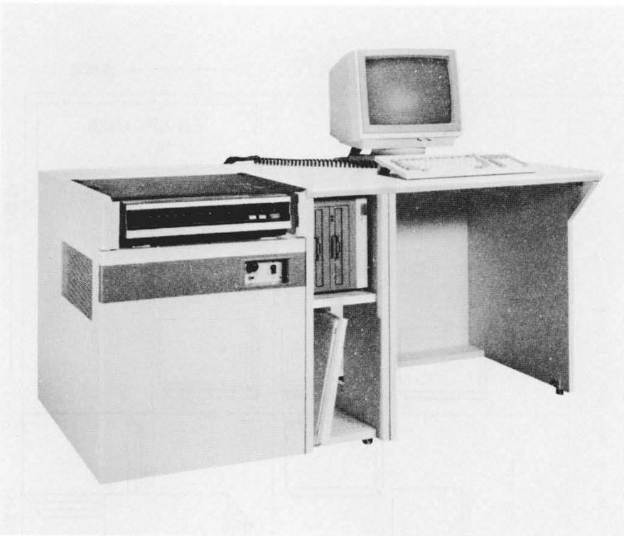
図2 画像応用CAI装置の外観 左側のデスクの上に光ビデオディスクプレーヤ、デスクの内に16ビットパーソナルコンピュータと高精細処理装置が収納されている。
