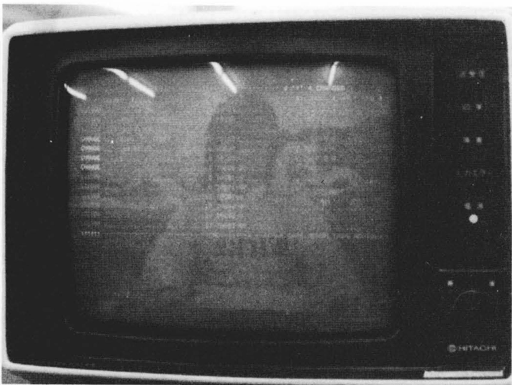
図6 CRT画面への映り込み例 CRT画面上に蛍光灯、作業者が映り込むと見やすさが著しく損なわれる。
