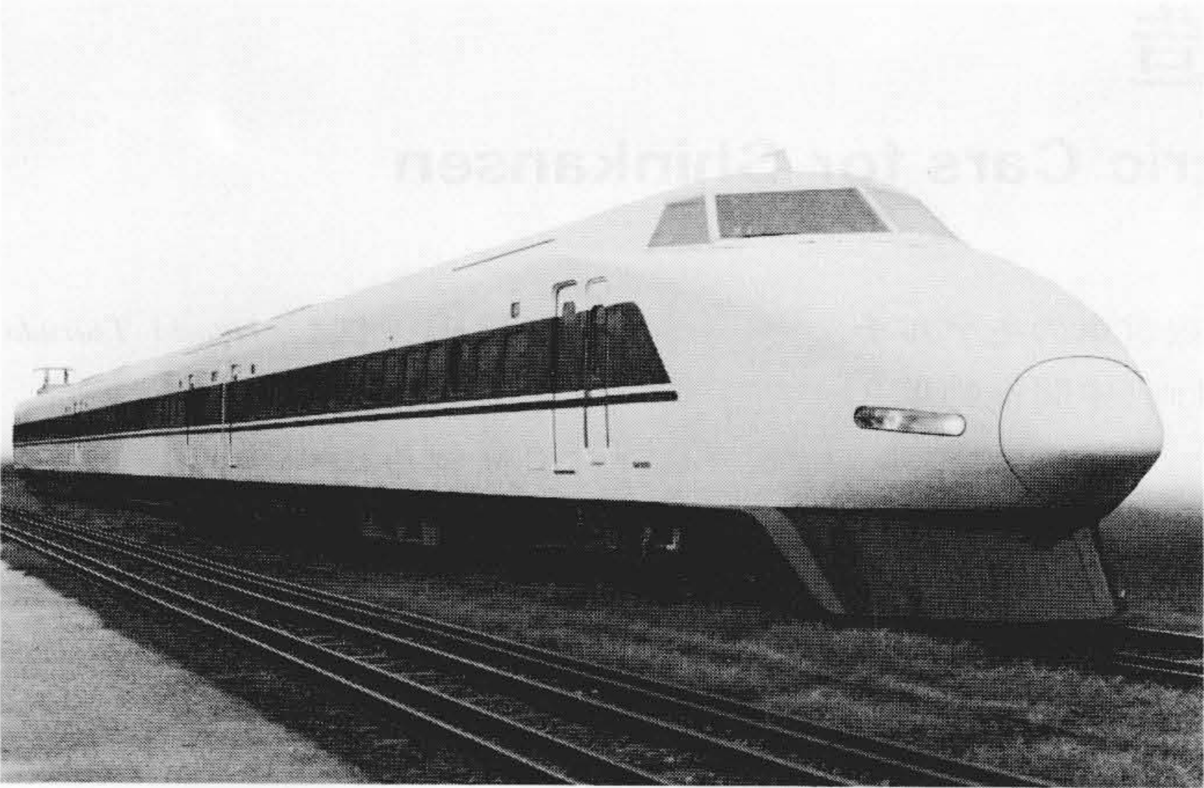
図1 100系新幹線電車の外観 従来の新幹線電車のイメージを踏襲しながら、よりスピード感のあふれる先頭形状とした。
