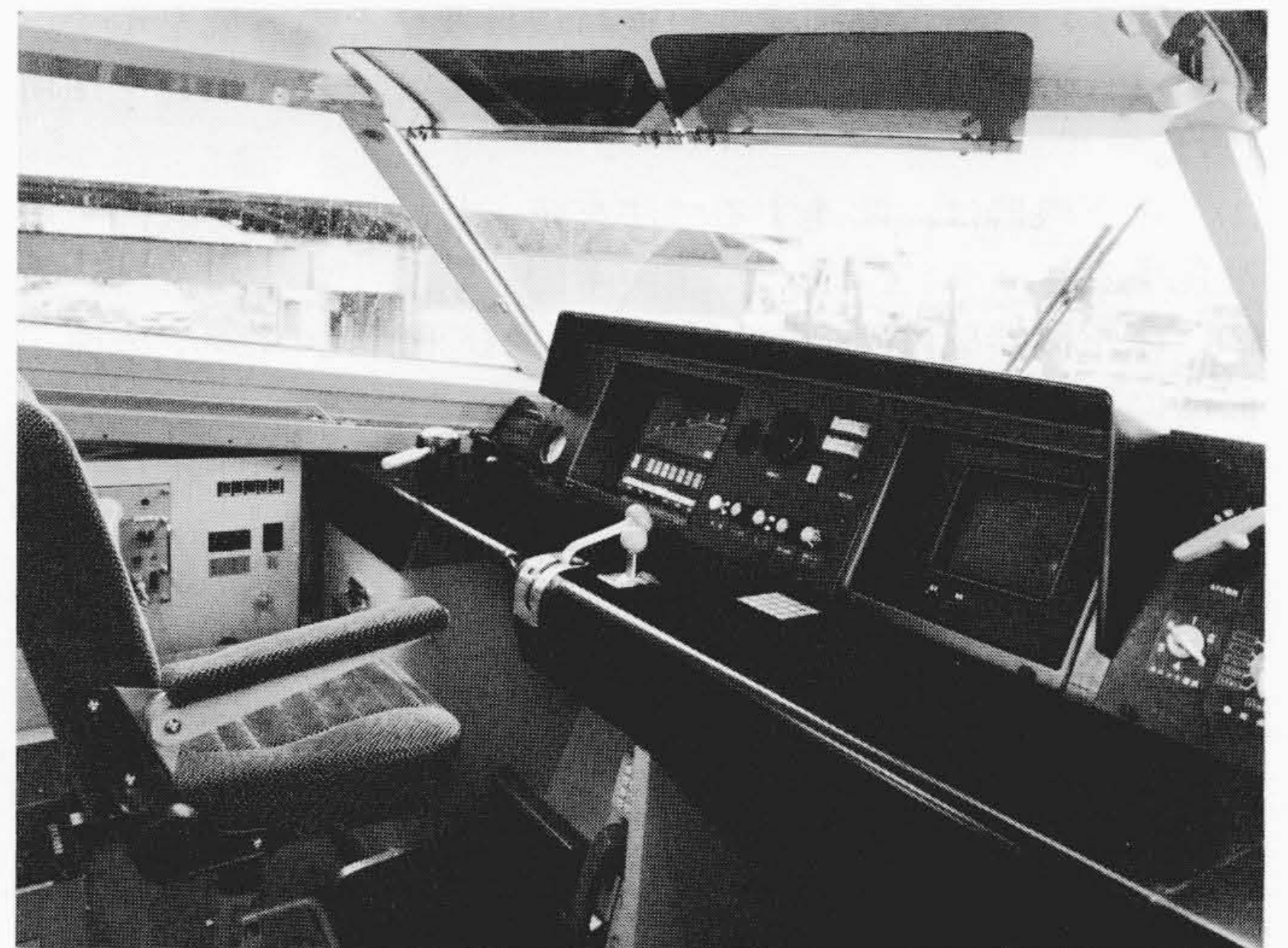
図5 運転台構造の外観 操作性、視認性向上のため、CRT、LED表示灯、アナデジ速度計を採用している。
