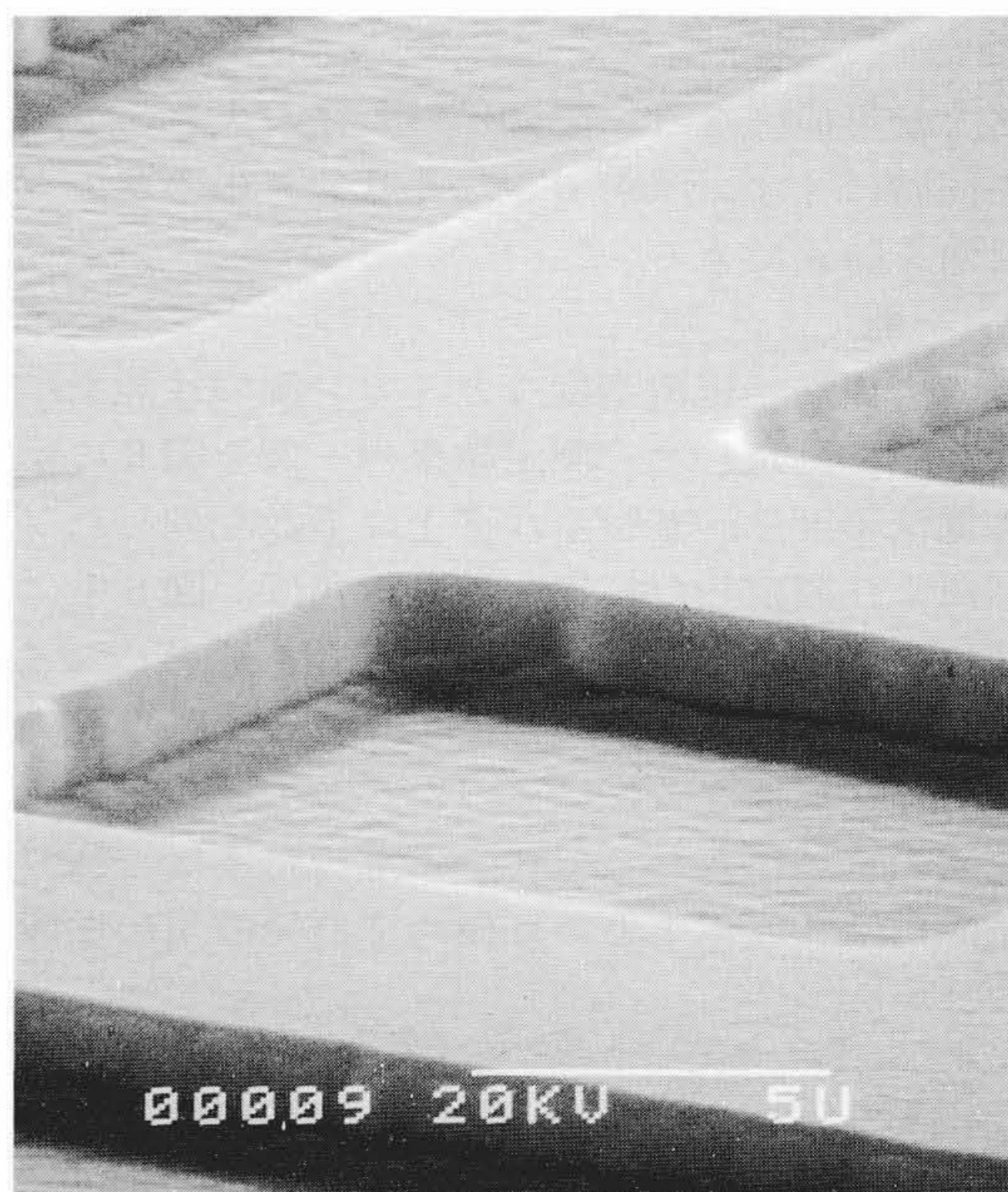
図10 ミリング状況の走査電子顕微鏡像(被加工材質：銅、イオン種：アルゴン) 再付着のないシャープなミリングを実現できた。
