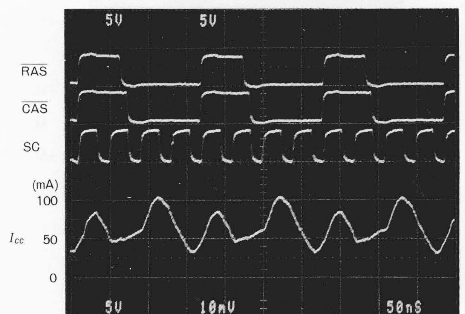
図7 動作時電源電流の波形 CMOSを用いているため低消費電力を実現しており、ピーク電流も100mAと通常のDRAM並み以下である。
