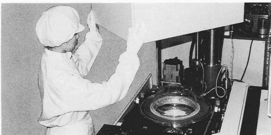
図5 “M-206A”のエッチング室 クリーニング作業のため、コイル部を上昇させた状態を示す。
