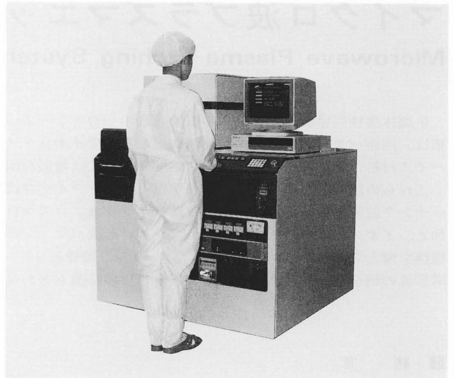
図3 “M-206A”の装置外観 左が処理室、カセット室などで構成される装置本体で、右がコンソール制御盤である。
