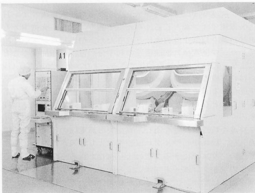
図1 IP-825形大電流イオン打込装置 本装置は、加速電圧120kVのマイクロ波イオン源と、打込室を2基装備した本体機構部、コンピュータ制御部及びウェーハローダで構成する。
