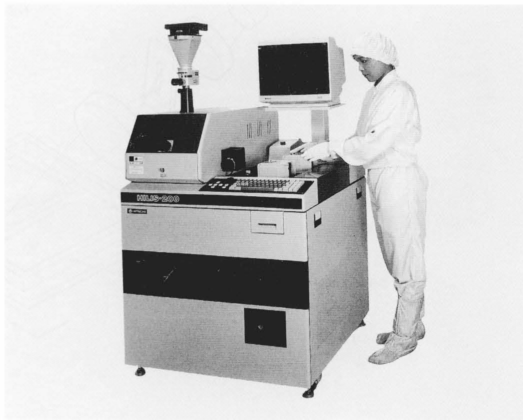
図7 ウェーハ上異物検査装置 検出した異物のウェーハ上の分布をディスプレイに表示する。検出異物を必要に応じて顕微鏡下に自動的に位置決めし、観察できる。
