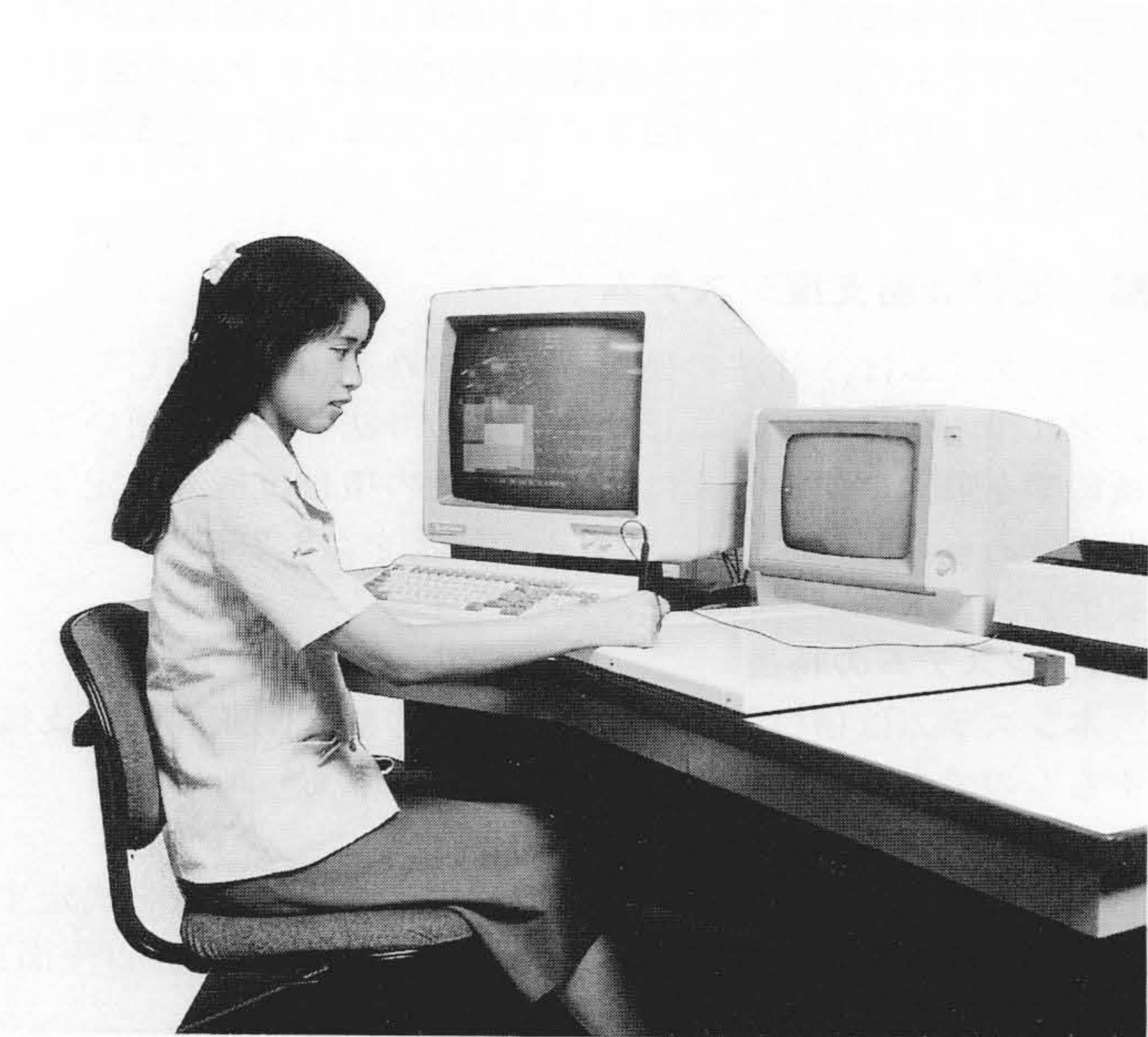
図2 積付計画支援システム 汎用のワークステーションであるHIDIC ES-310を採用した。16ビットマイクロプロセッサで積付配置の演算が可能である。
