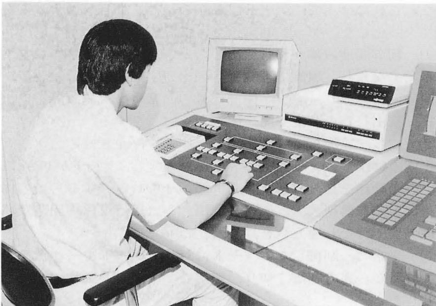
図7 障害監視装置 障害項目は、すべて本装置で集中監視するとともに、連絡先への通報も本装置から行なう。
