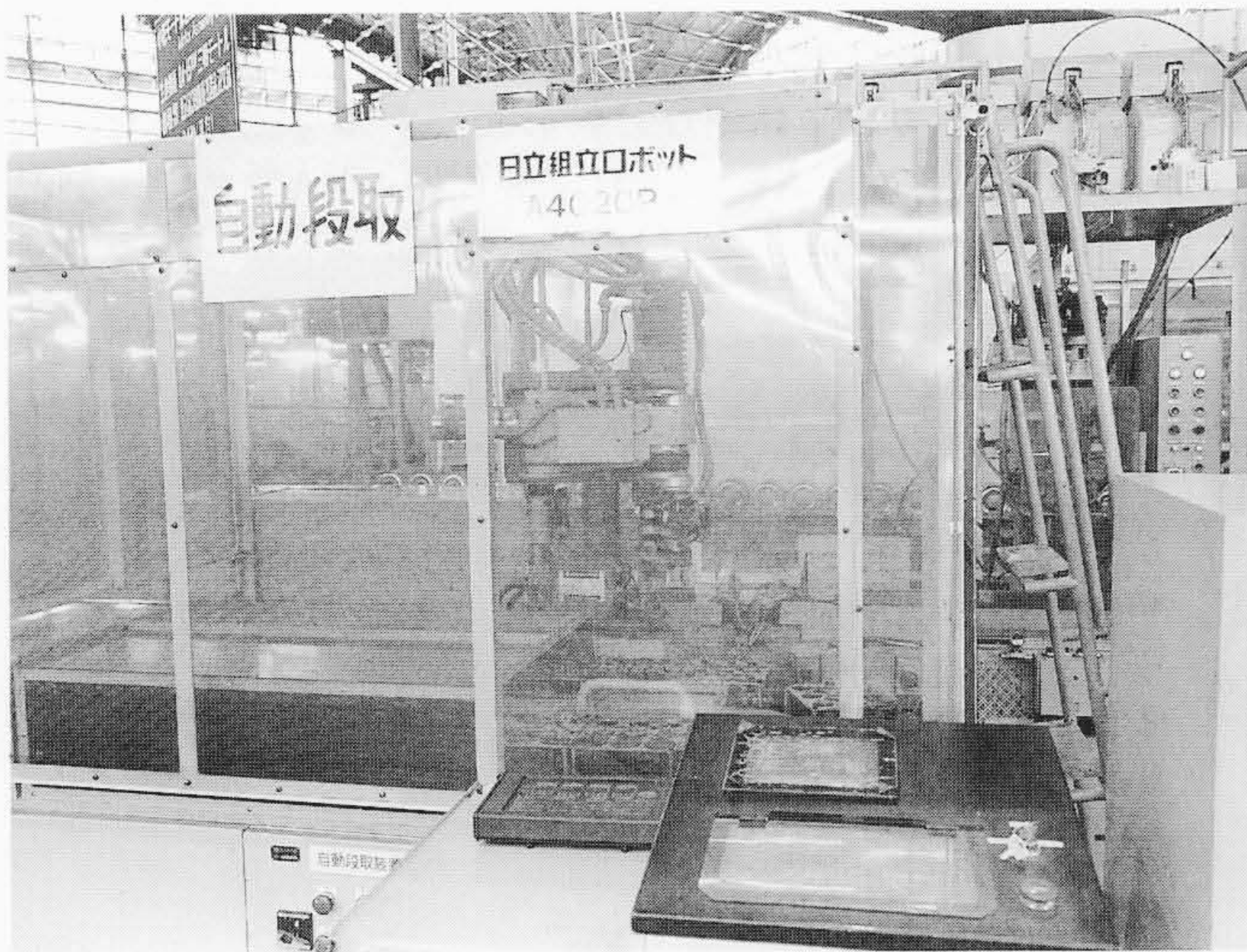
図9 組立ライン自動段取用ロボット (A4020) 組立ライン上の治具を、機種変更のつと自動的に入れ替える。
