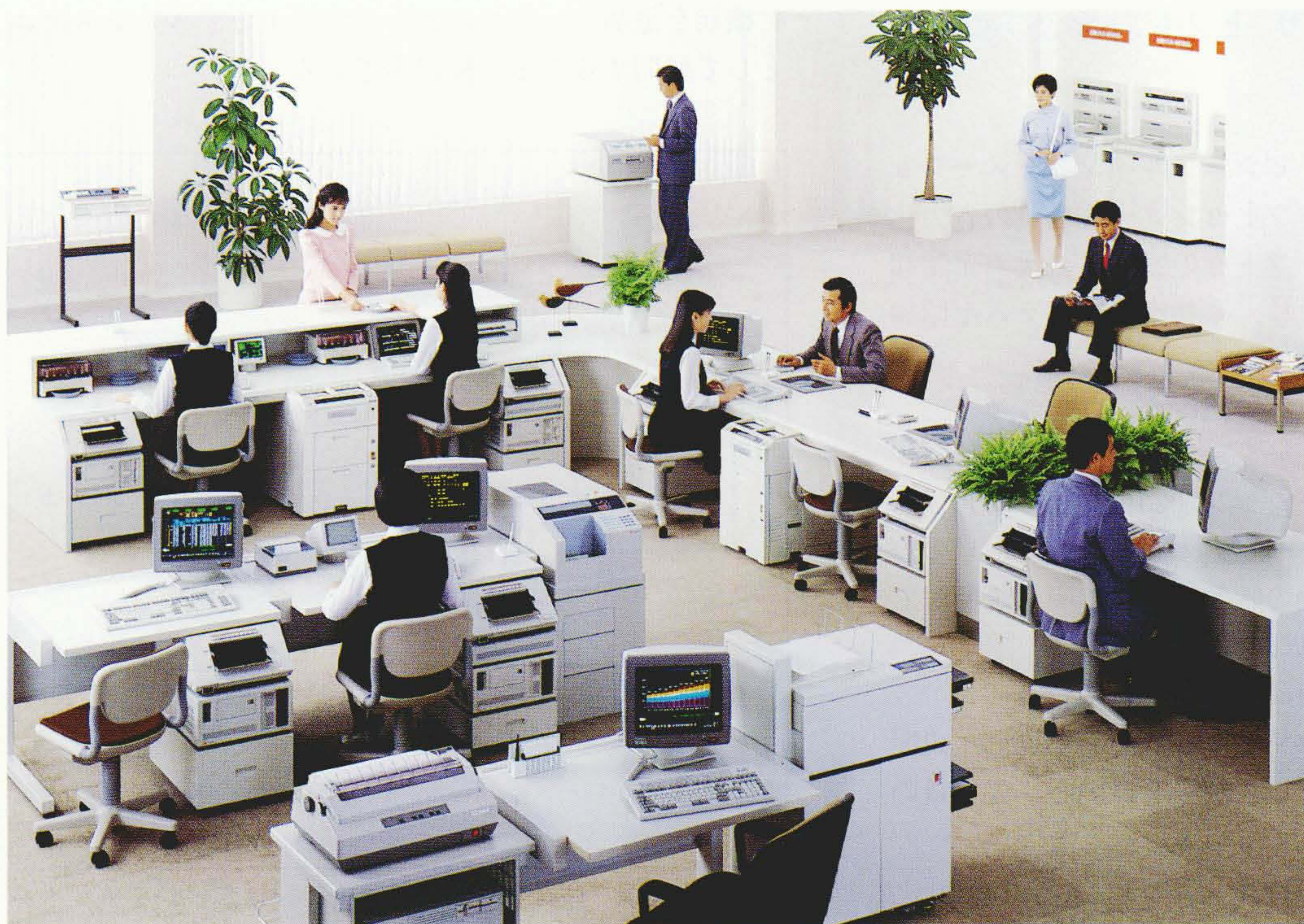
HITAC T-860/20 金融機関営業店システム カウンタ 左側がハイカウンタシステム、右側がローカウンタシステムで、手前が役席端末とページプリンタ、中央が通帳証書発行装置である。
