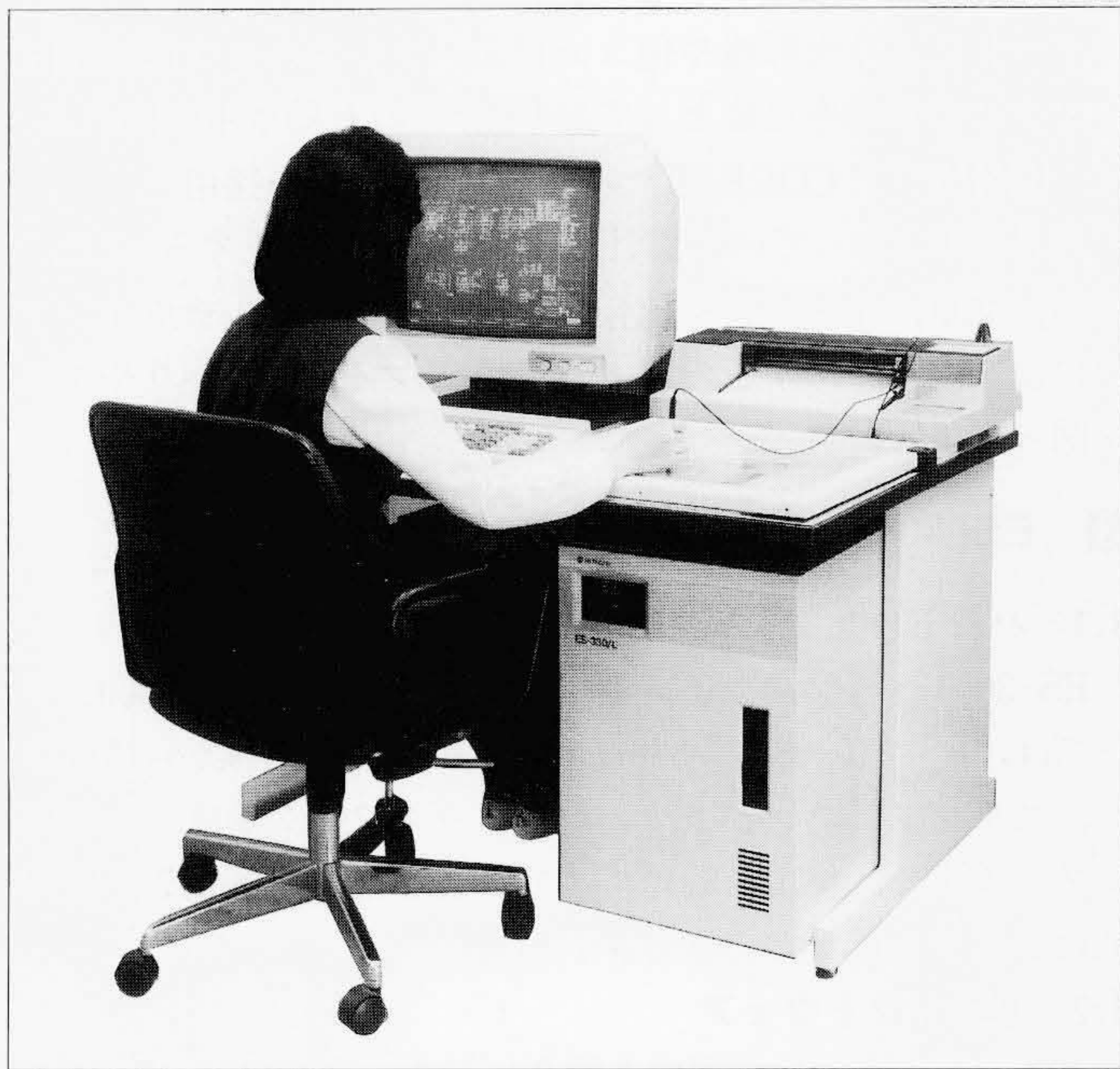
図1 エンジニアリングワークステーションES-300シリーズ 本体部(高性能マイクロコンピュータ、グラフィックプロセッサ、磁気ディスク)、高精細グラフィックス、マウスなどから構成される。
