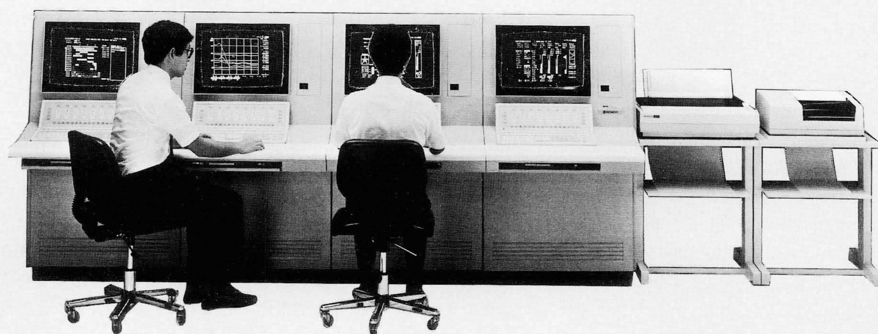
図2 EX-1000シリーズのオペレータコンソール 20inカラーCRT、専用キーボード、プリンタなどから成る。プロセスの操作・監視と計測・制御機能の作成・変更を行う。
