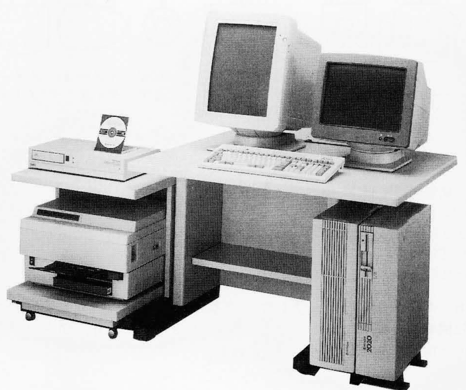
図5 CD-ROM端末の外観 処理用とイメージ表示用の2CRT (Cathode Ray Tube)構成である。
