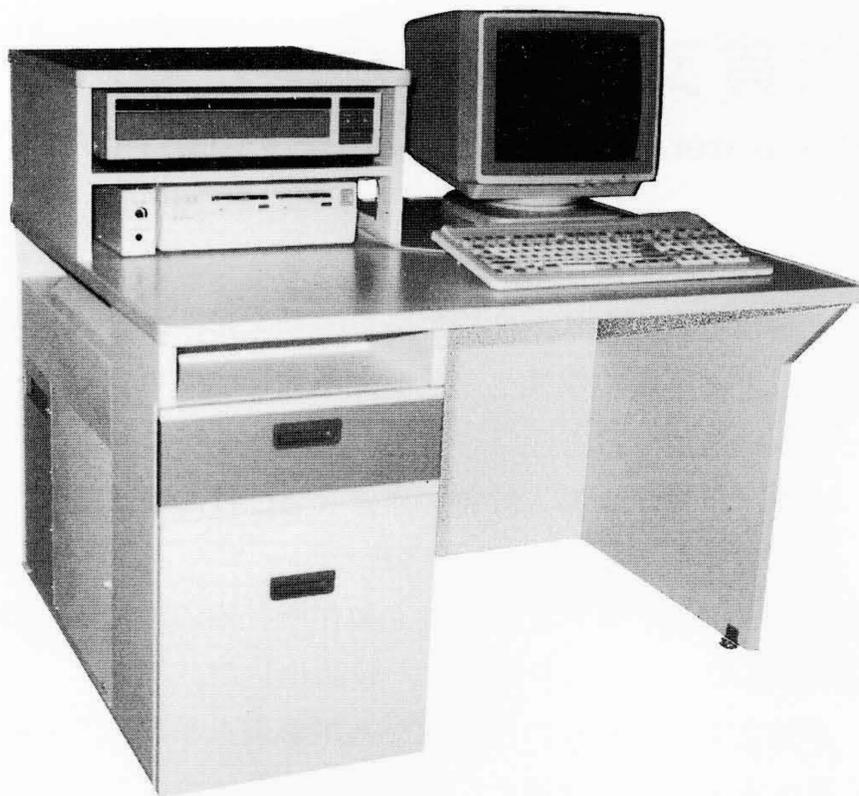
図2 P-VIEWの外観 機の左そでの下に、高精細処理装置が収容されている。
