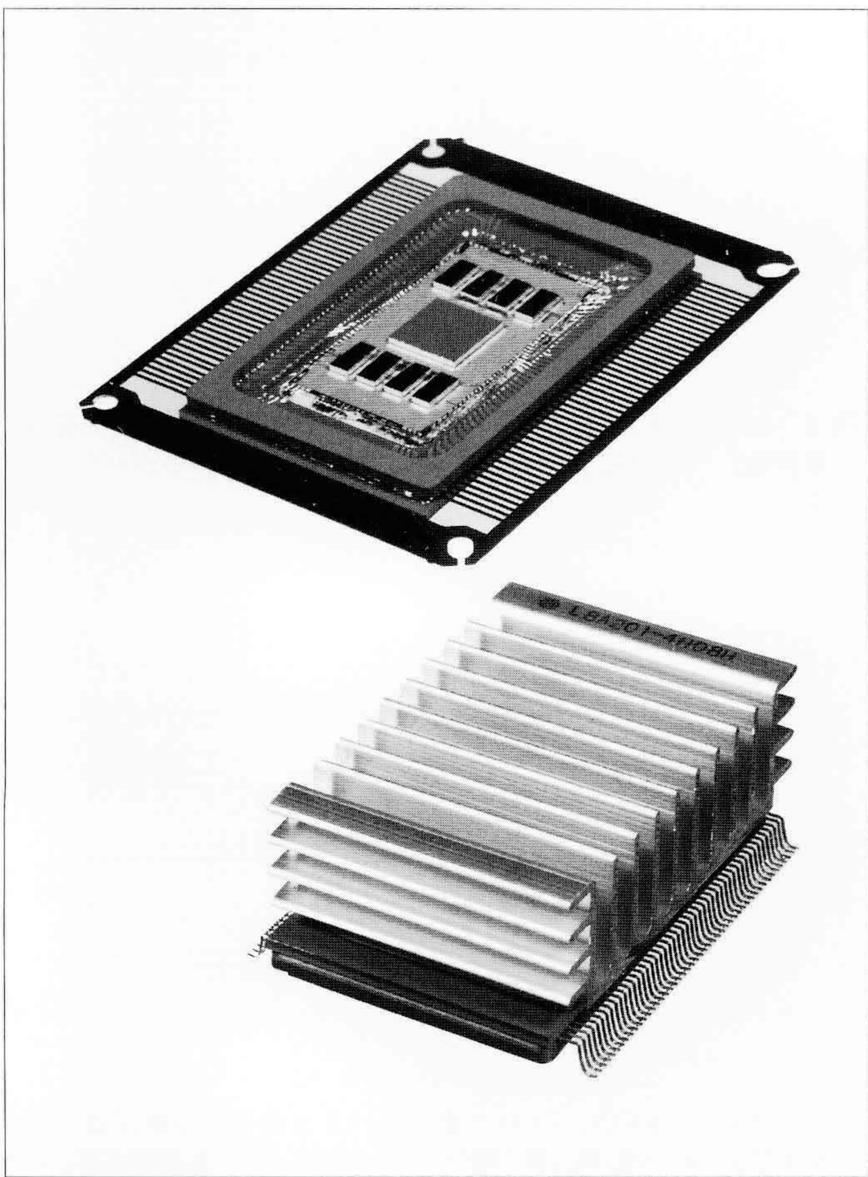
図12 メモリモジュール 4kビット/2.5ns typのRAMチップ8個と0.7kゲートで0.2ns/ゲートの論理チップをシリコン配線基板上に直接搭載し、メモリモジュール化している。
