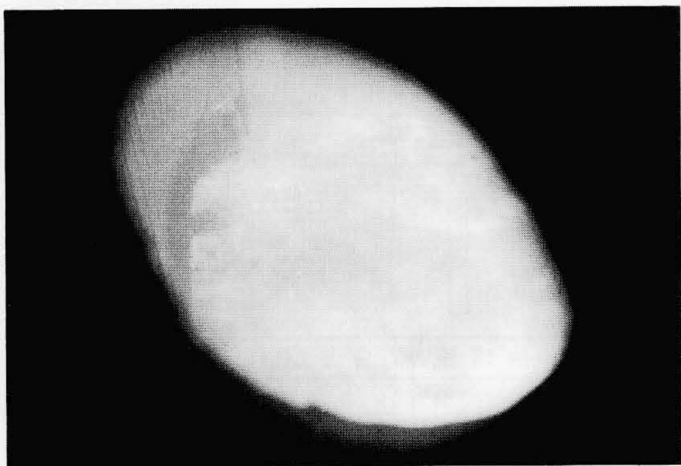
図12 日立-NRバーナの低NO x 燃焼原理と火炎状況 揮発分の分解によって高温雰囲気中で還元剤を発生し、火炎内で脱硝反応を形成する。
