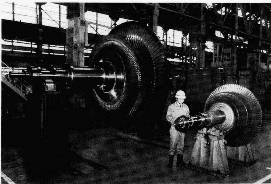
図9 完成した実物大試験タービンロータ 2台の試験タービン用ロータを示す。手前は $\frac{1}{2.5}$ 縮小モデルロータで、後方は実物大モデルロータである。
