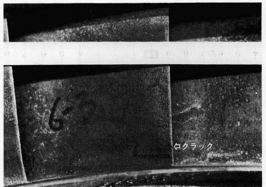
図1 クラックが発生したノズルの一例 長時間運転後のノズルに発生したクラックの状況を示す。
