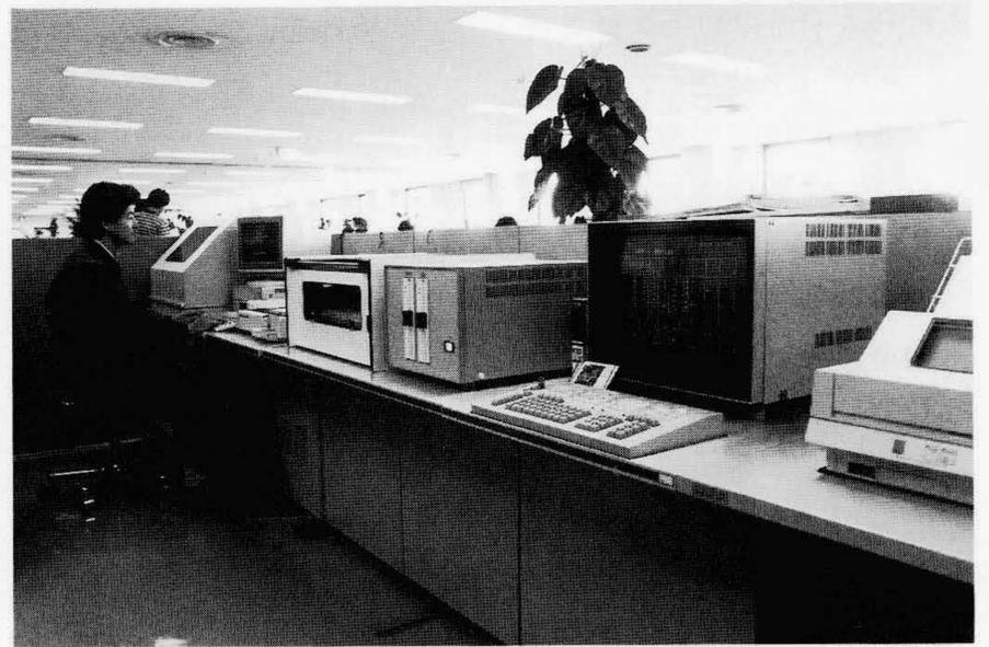
図3 サービスビル設置入出力端末の外観 サービスビル事務室の入出力端末を使用し、管理用計算機システムの各種データを手軽に利用できる。
