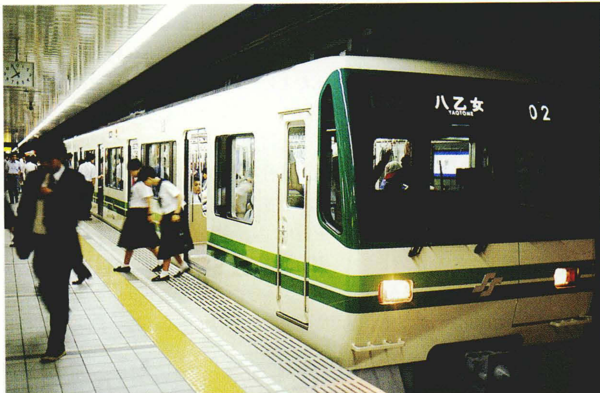
運転台のある車両はその分だけ長く設計されており、どの車両も全く同じ座席配置となっている。車両連結部はオープン式で、見通しも良い。
