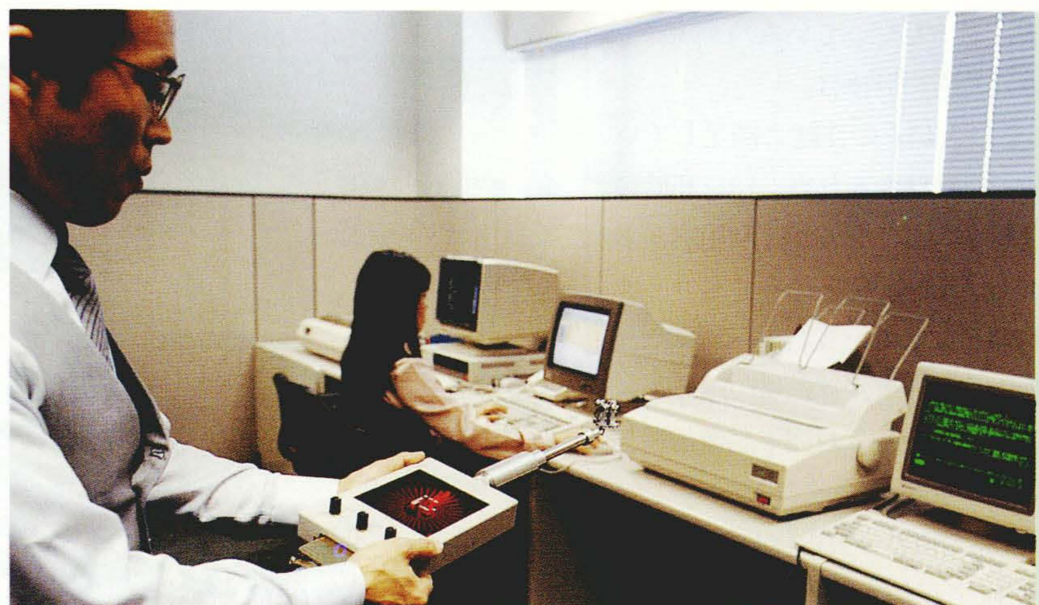
機械研究所で開発された現場で手軽に使えるポータブル形 二次元音場可視化装置
