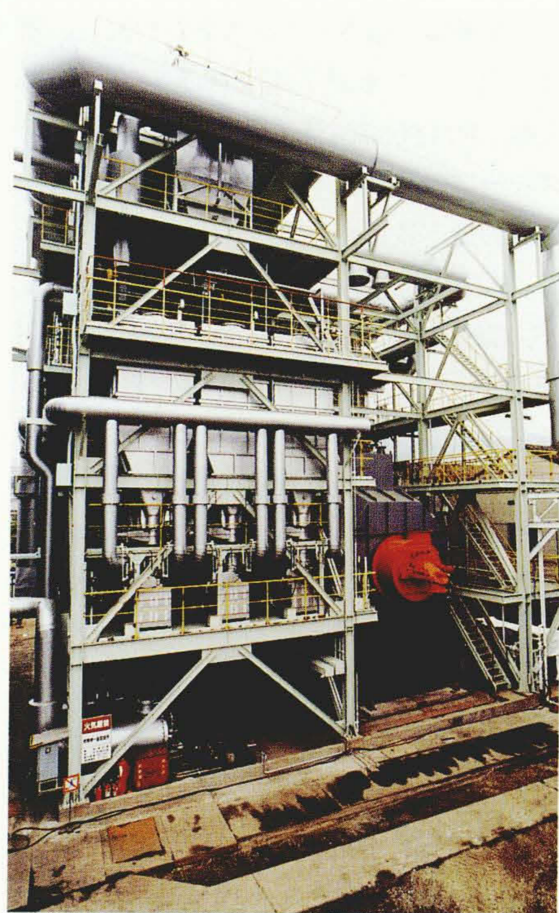
火力発電所の中間負荷運用化に対応した実験ができる大型燃焼試験設備
