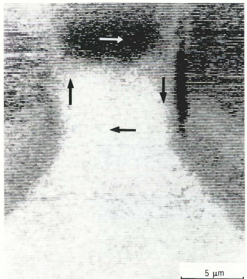
図2 多層膜磁気コア先端部の磁区構造
