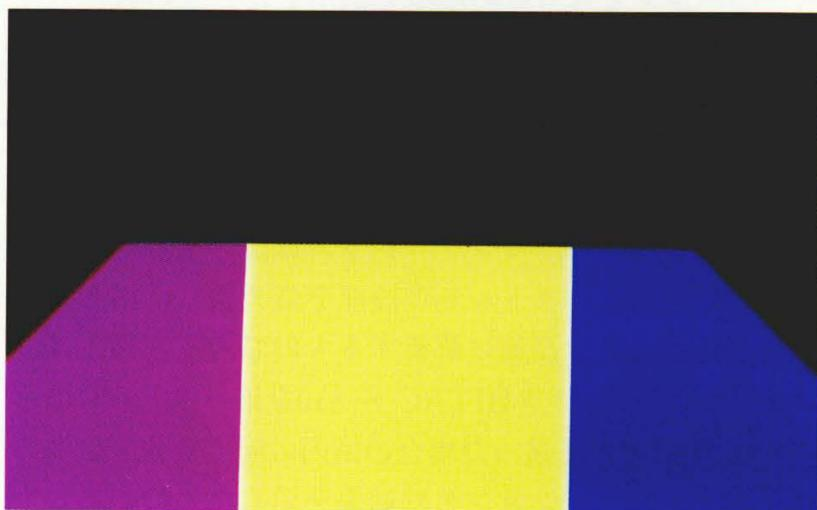
直刃ダイヤモンドバイトすくい面の微分干渉顕微鏡写真(すくい面が3面で構成される特殊バイト)
