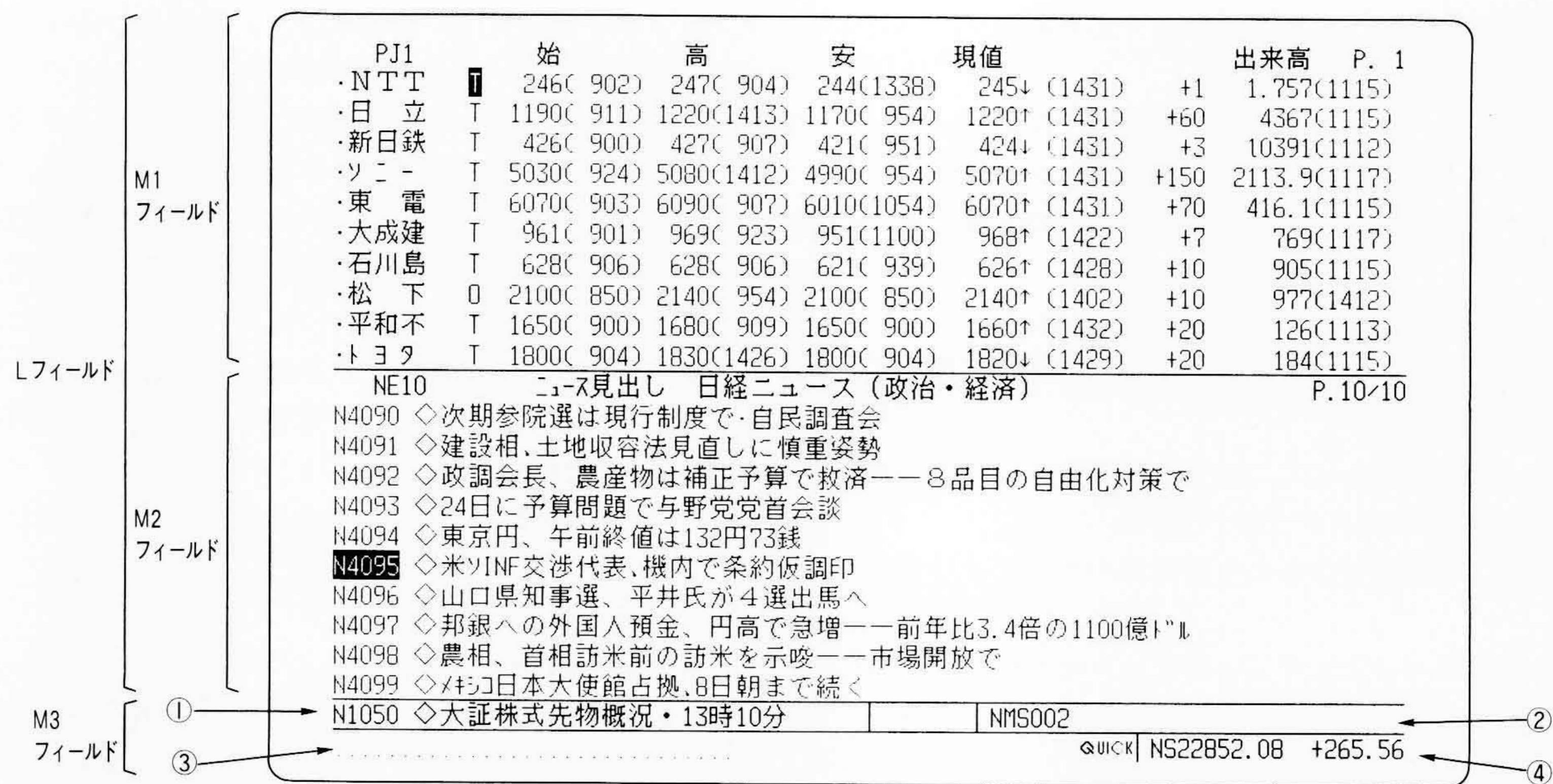
図5 QUICK-10端末のマルチスクリーン構成 ①のニュース・市況速報フィールドは、リアルタイム自動更新で、世界の重要なニュース、市況速報の問合せコードと見出しを表示する。②の情報連絡入力通知フィールドは、情報関連機能を用いて伝達された情報の問合せコードを自動更新で表示する。③の操作モニタ・操作メッセージフィールドは、問合せ操作のモニタ表示やエラーメッセージなどを表示する。④のインデックスフィールドは、株式指標又は外国為替指標を表示する。
