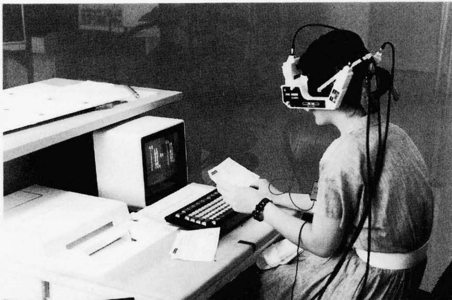
図10 アイマークレコーダによる目視作業評価 伝票読取り，キー入力，CRTでの内容確認の一定作業で，CRTの配置(中央，左側)による入力のしやすさを生理的に評価を進めた。
