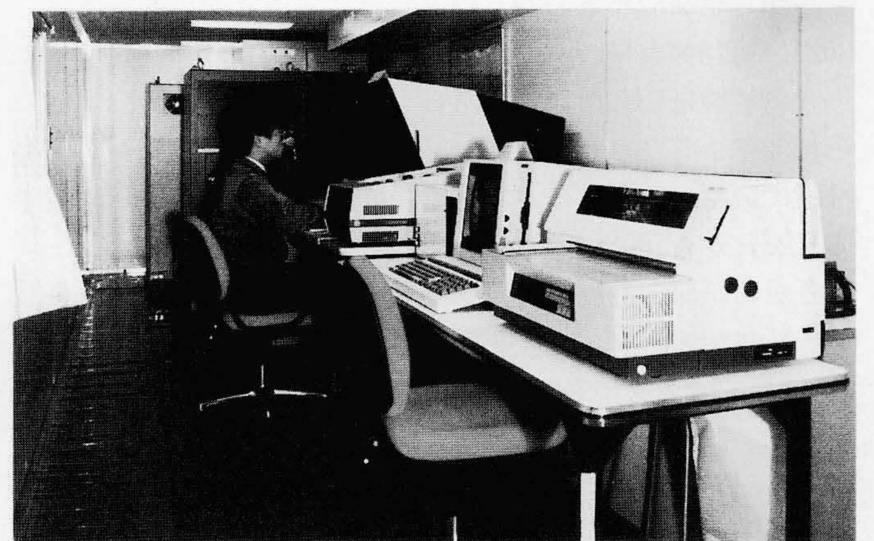
図8 小口径管FA工場の状況 現地に、CAD/CAM(Computer Aided Design/Computer Aided Manufacturing)を駆使した小口径管FA(Factory Automation)工場を設置することにより、据付けの効率化を図った。
