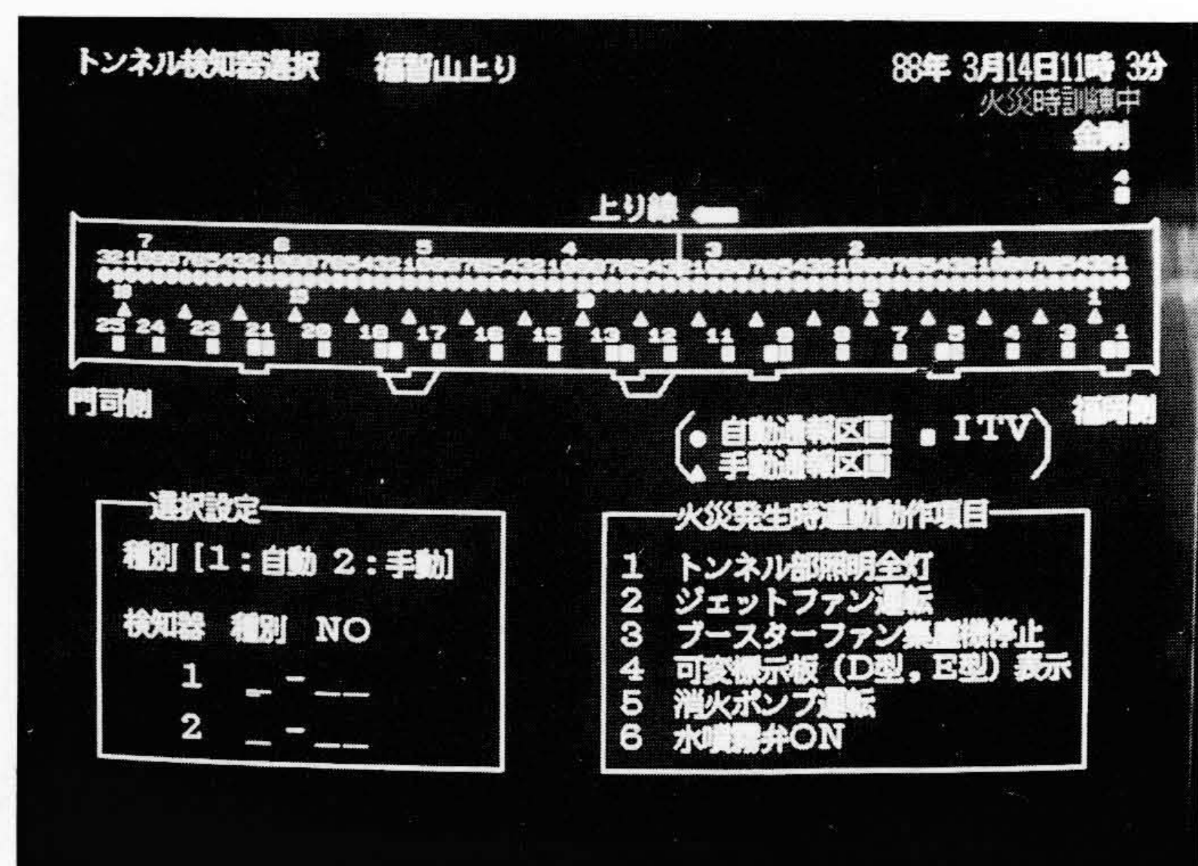
図4 防災訓練用の画面例 火災発生地点を入力し、緊急時に備えて操作訓練を行う。
