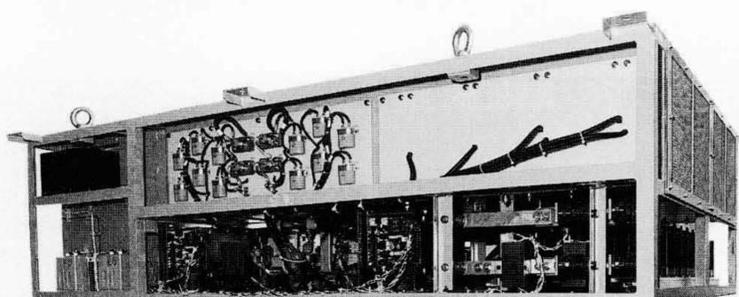
注：容量(1,440 kW), 直流出力電圧(1,900~2,280 V)
