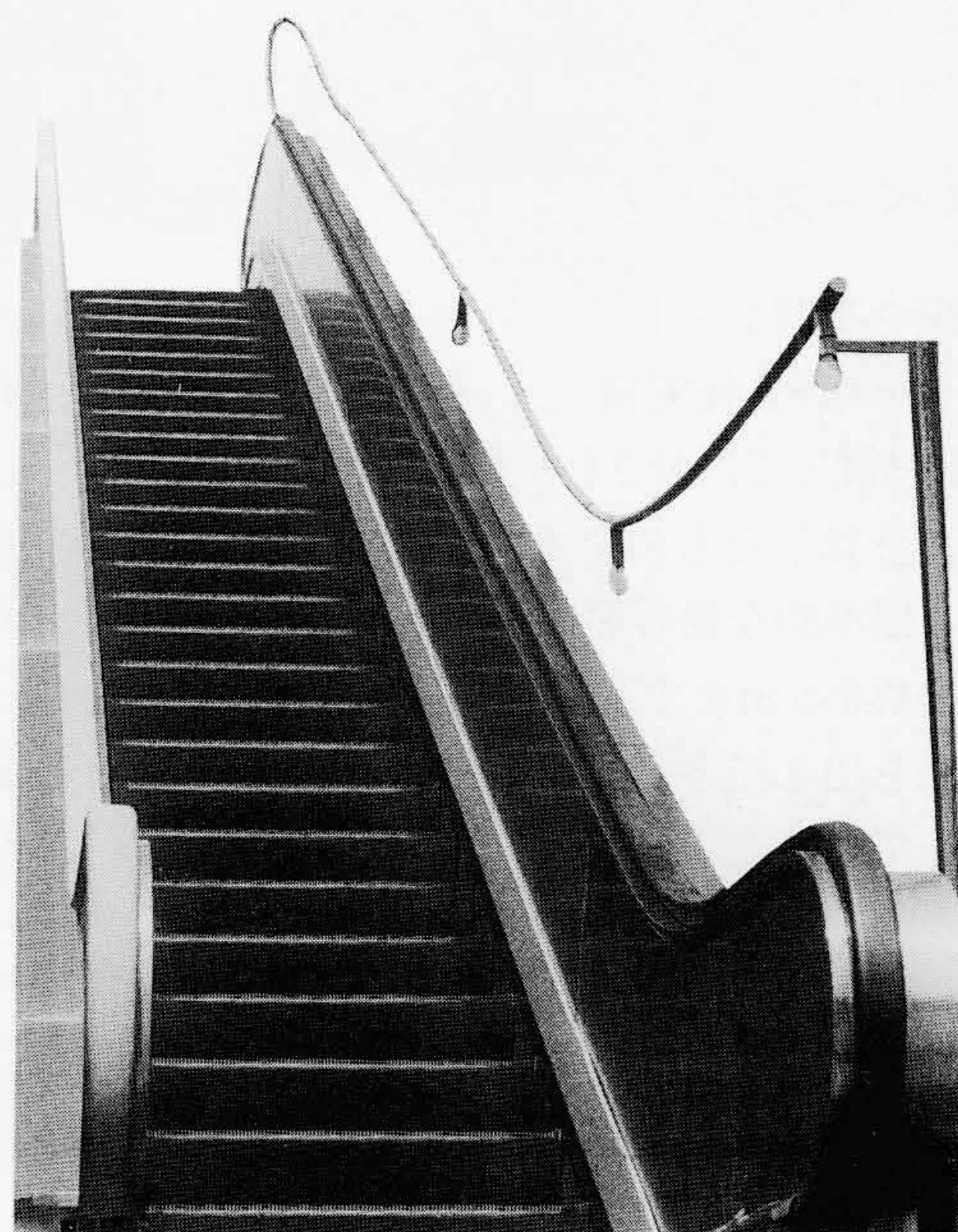
図1 屋外に設置した「CXシリーズ」エスカレーター 屋外に設置して降雨、降雪、塩水などの過酷条件下で試験をした。
