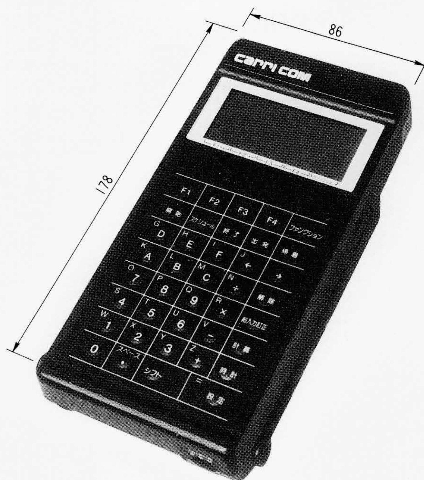
図5 キャリングメンテナンスコンピュータの外観 専用インタフェースを介して、エレベーター制御用マイクロコンピュータの保守に用いられる。
