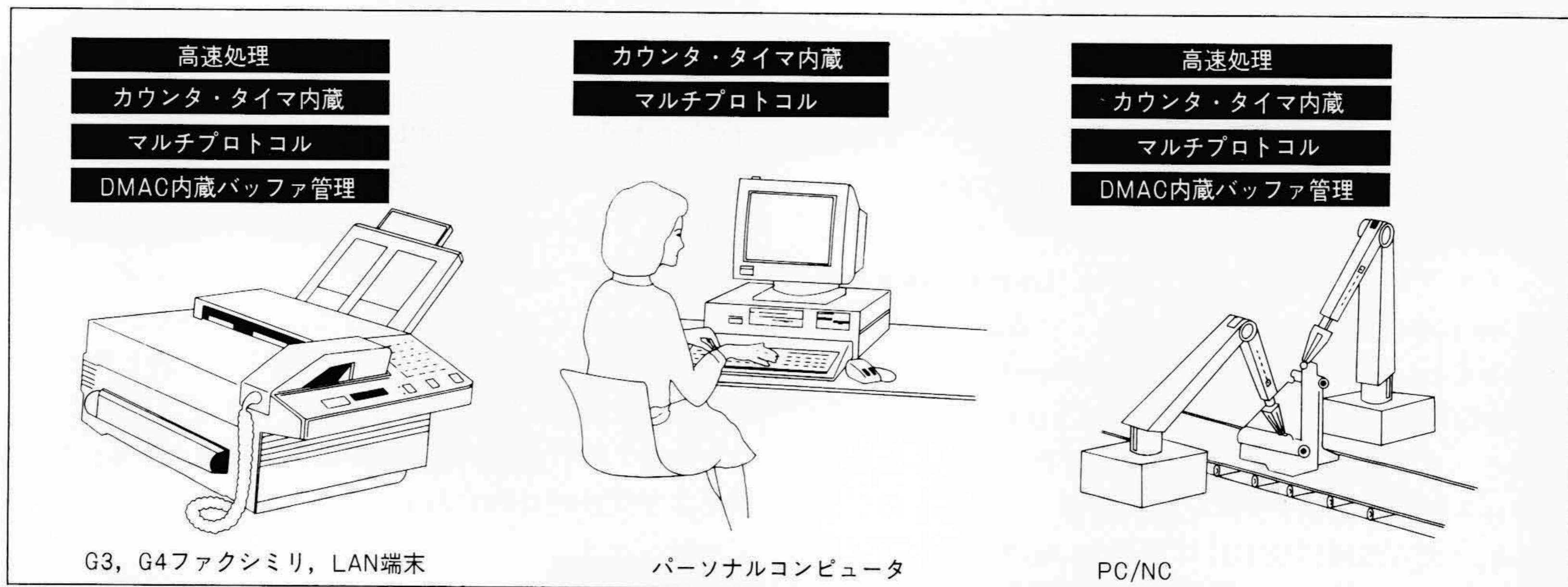
図2 NPUの応用例 NPUはファクシミリ，LAN端末，パーソナルコンピュータやNC機器などの応用に適した機能を内蔵している。
