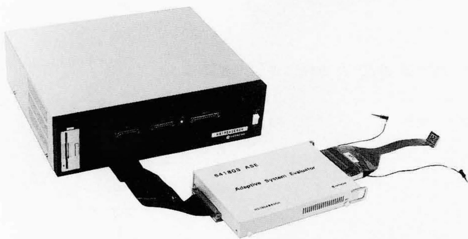
図11 ASEの外観 ASEは本体とバッファボックスから成っている。本体はHD64180のものを流用できる。
