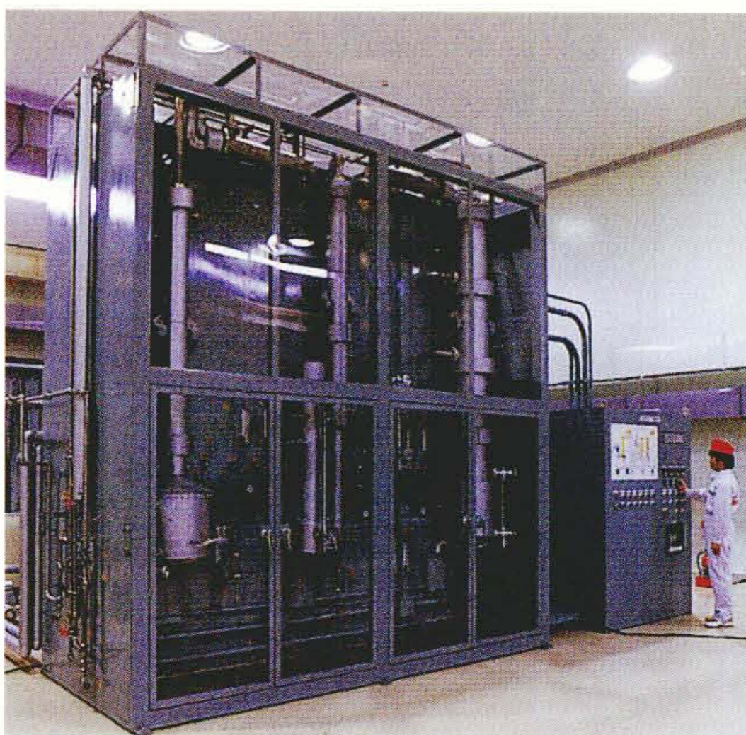
核分裂生成物化学挙動実験設備(実機の \frac{1}{200} 規模)
