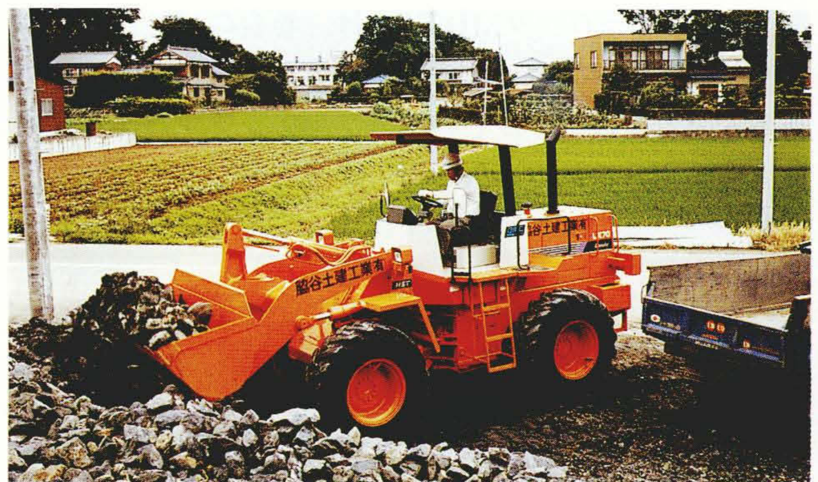
投石を積み込み稼働中のランディLX70
