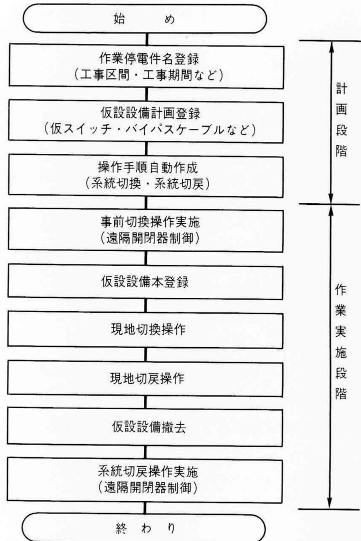
図4 作業停電操作機能の全体フロー 作業停電操作業務の流れを示し、「遠制による事前切換」「現地停電操作」「現地切戻操作」「遠制切戻操作」の手順はグルーピングして作成される。
