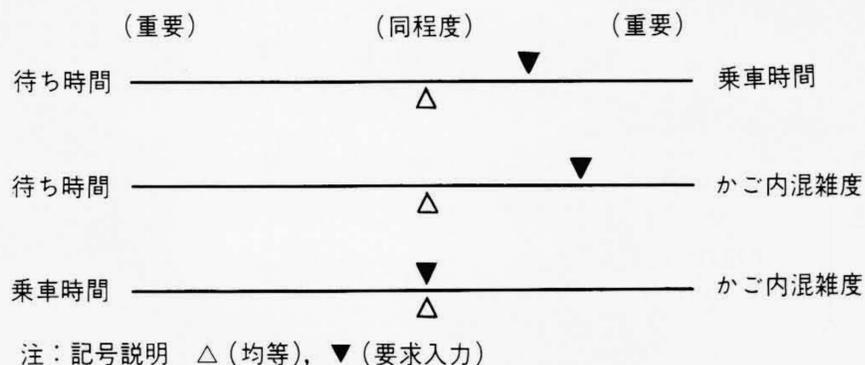
図3 要求入力図 要求入力は、画面上でカーソルを移動させて制御目標相互の重要度を感覚的に入力する。
