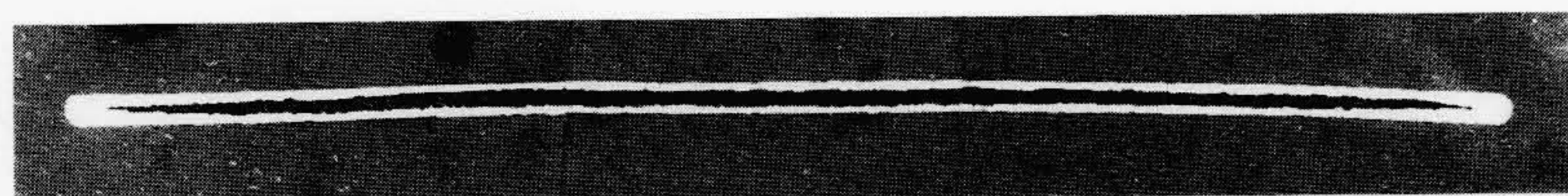
(b) TBSCCO/Agテープ焼結材の断面写真(厚さ0.07 mm×幅4 mm)
