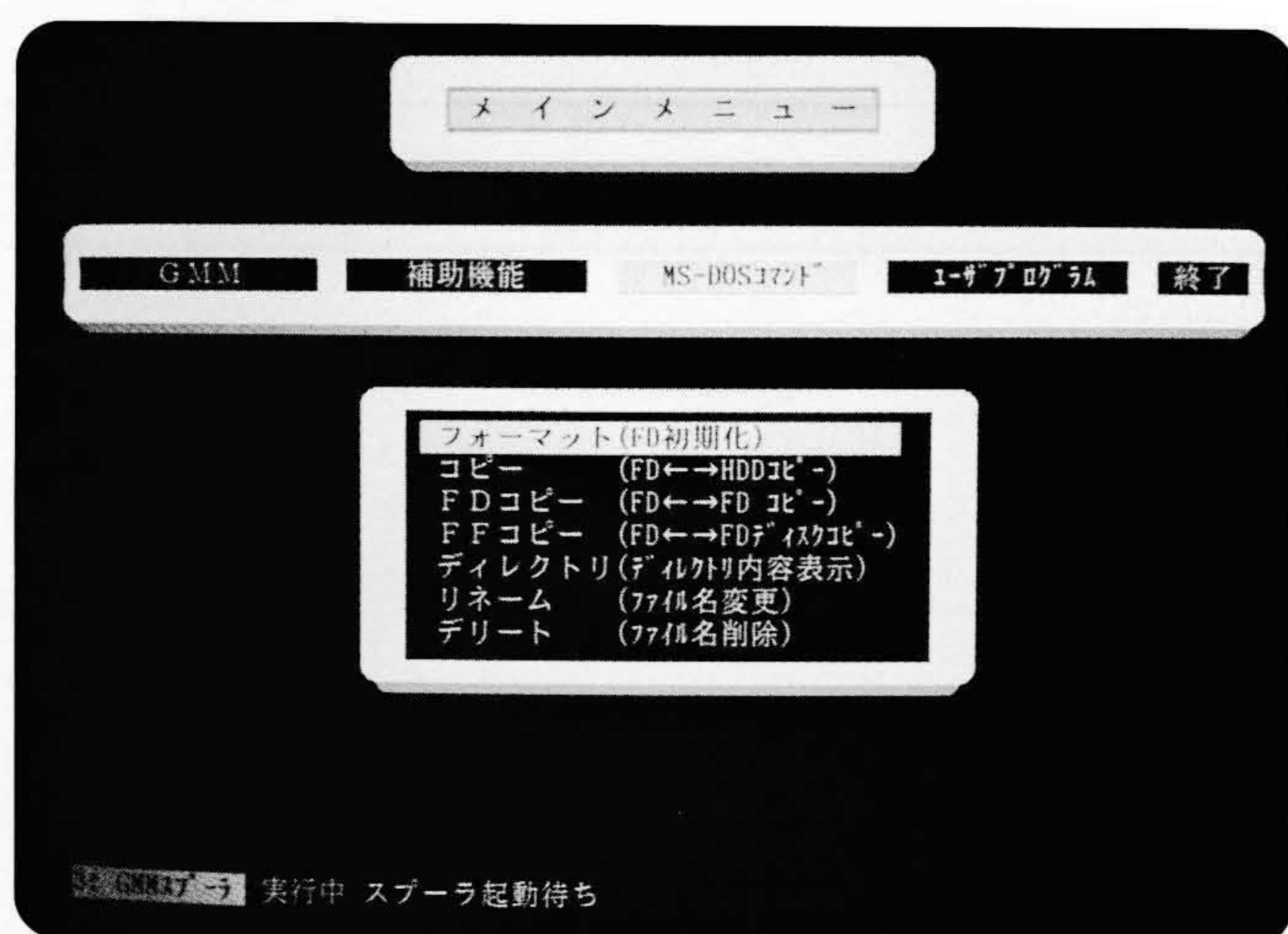
図4 メニュー選択プログラムの画面 電源投入後、この画面が表示されGMMのすべての操作を実行できる。OSを意識せず、またOSの知識もいらないと好評である。
