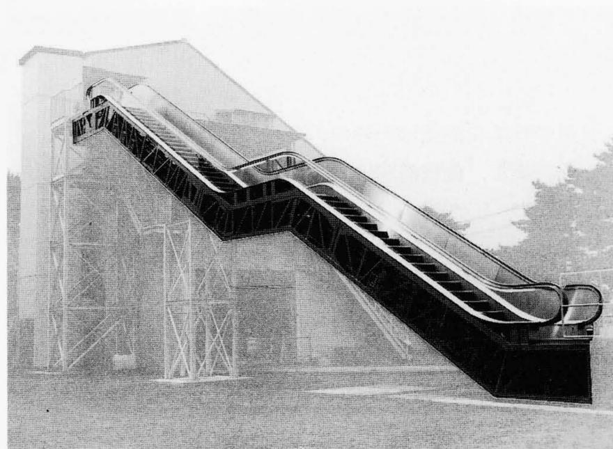
図1 中間水平形エスカレーターの外観 欄干の左側を透明形で、右側を不透明形で試作した。
