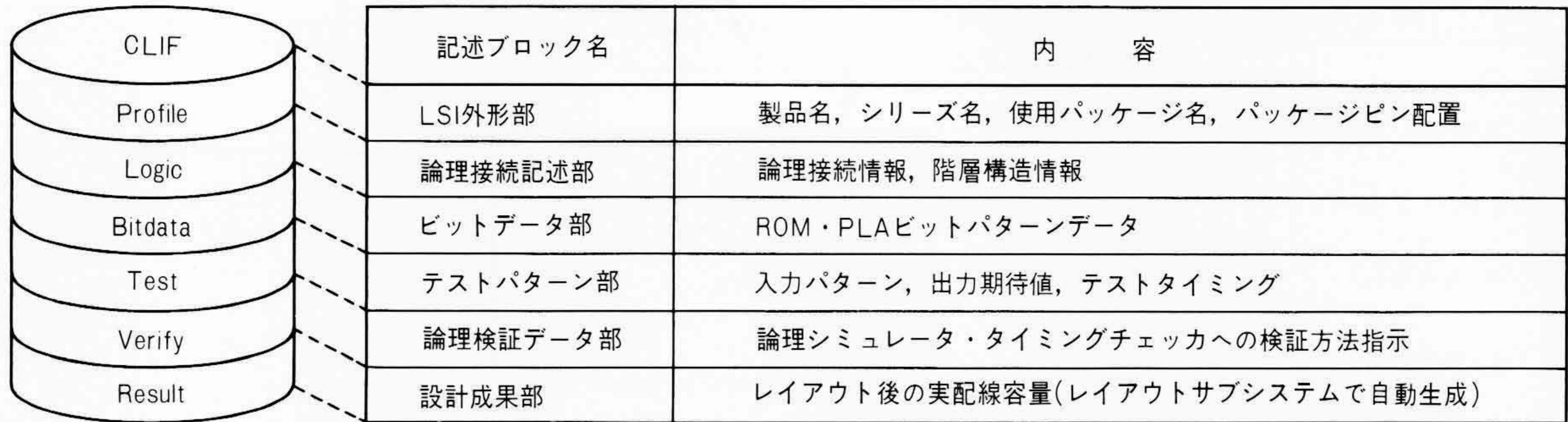
図3 CLIF記述内容 LSIの設計データを異なるDA環境間で受け渡しするために、必要な情報項目を用意した。
