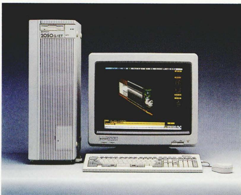
立体設計システムによる三次元設計の例
