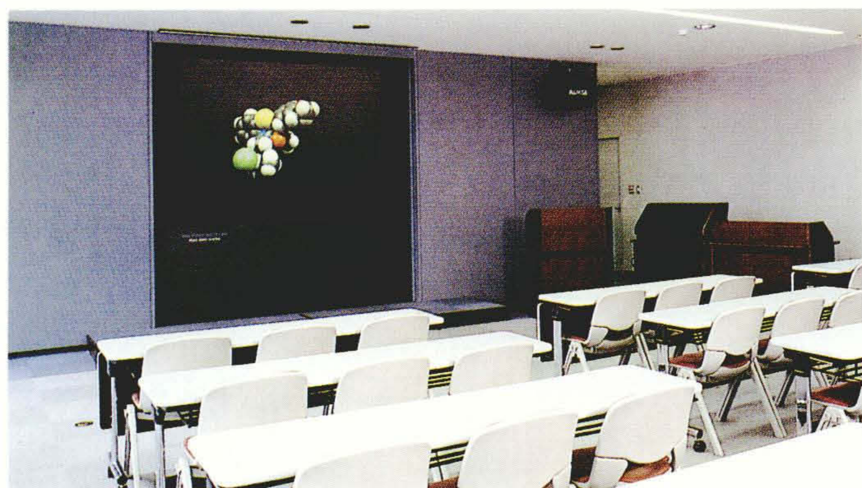
図8 田辺製薬株式会社東京工場厚生棟大ホール設置の110形高精細背面投写形ディスプレイ 110形ディスプレイを壁面に組み込み、視野角を考慮した機の配置になっている。
