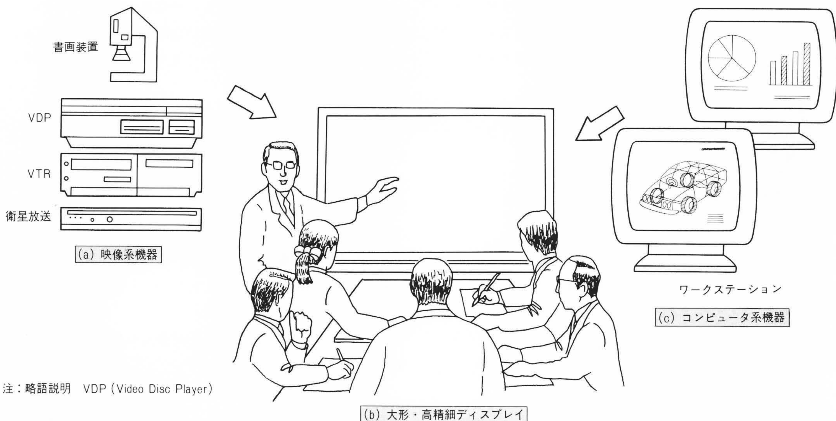
図2 主な構成要素 大形ディスプレイを中心に映像系機器、コンピュータ系機器から成る。
