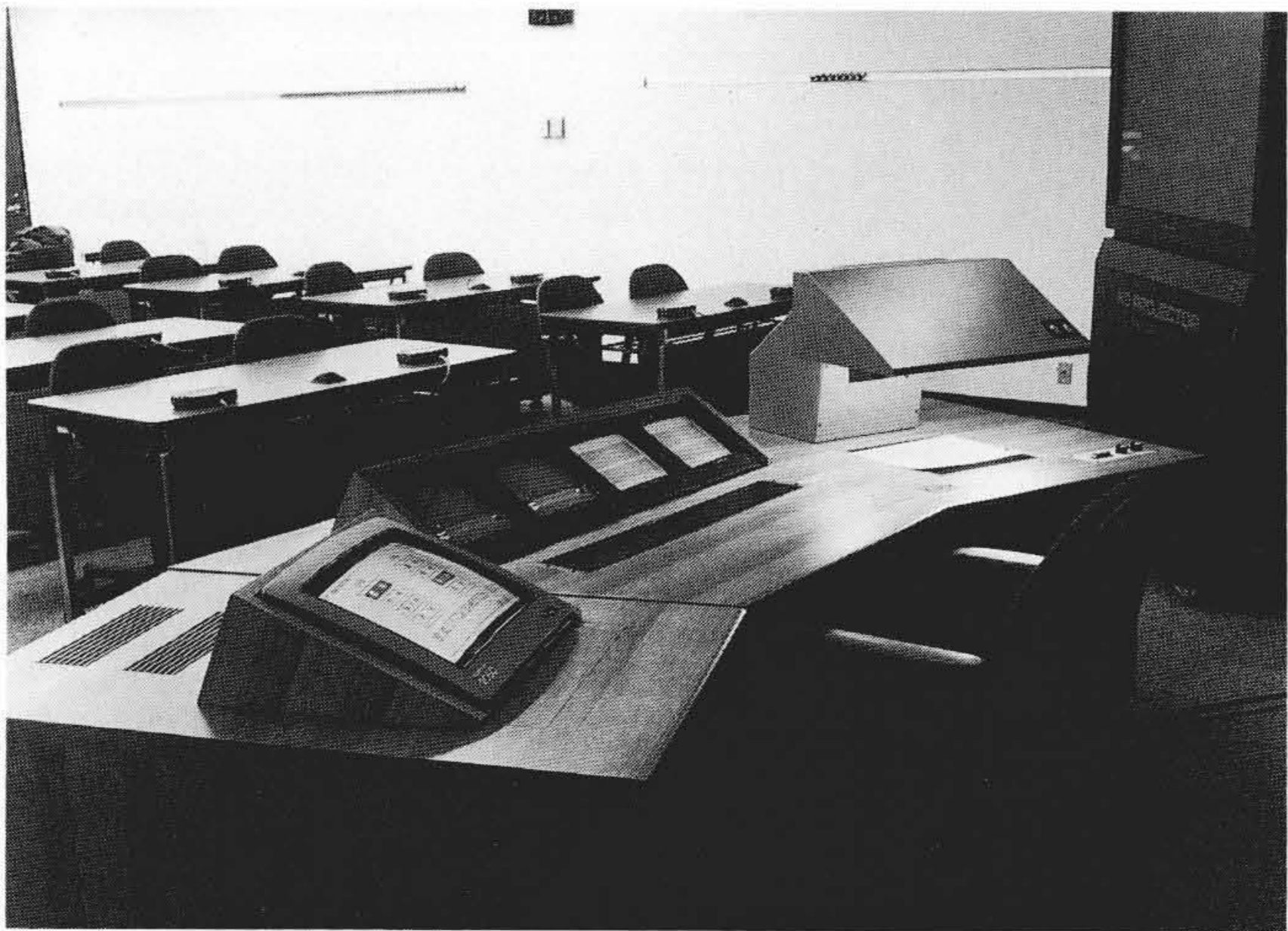
図3 講師卓 システム制御装置により、システム全体を制御しながら講義を行う。
